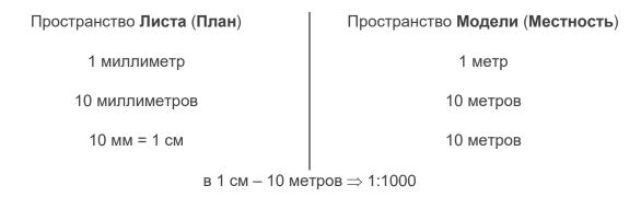
Таким образом, масштаб 1:1 в AutoCAD соответствует топографическому масштабу 1:1000
